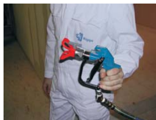
Pištolj sa filterom služi za fino (sprej) prskanje boje i samočišćenje mašine.
