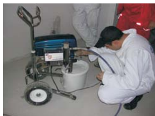
Postavljanje kante sa disperzijom ispod usisnika Graco Mark V mašine.
